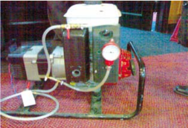
Máy bơm cải tiến chạy bằng khí bioga
